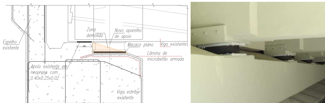
Figura 9. Introdução de novos aparelhos de apoio nos encontros
