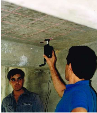
Figura 14 - Ensaio de medição do potencial eléctrico e da resistividade do betão
