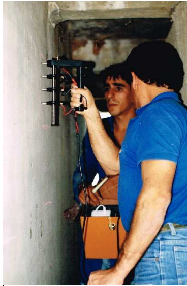
Figura 14 - Ensaio de medição do potencial eléctrico e da resistividade do betão
