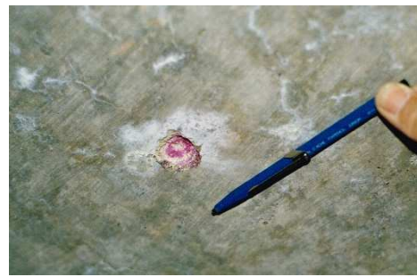
Figura 12 - Medição do recobrimento das armaduras e profundidade da carbonatação
