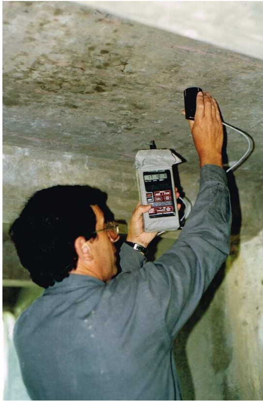
Figura 12 - Medição do recobrimento das armaduras e profundidade da carbonatação
