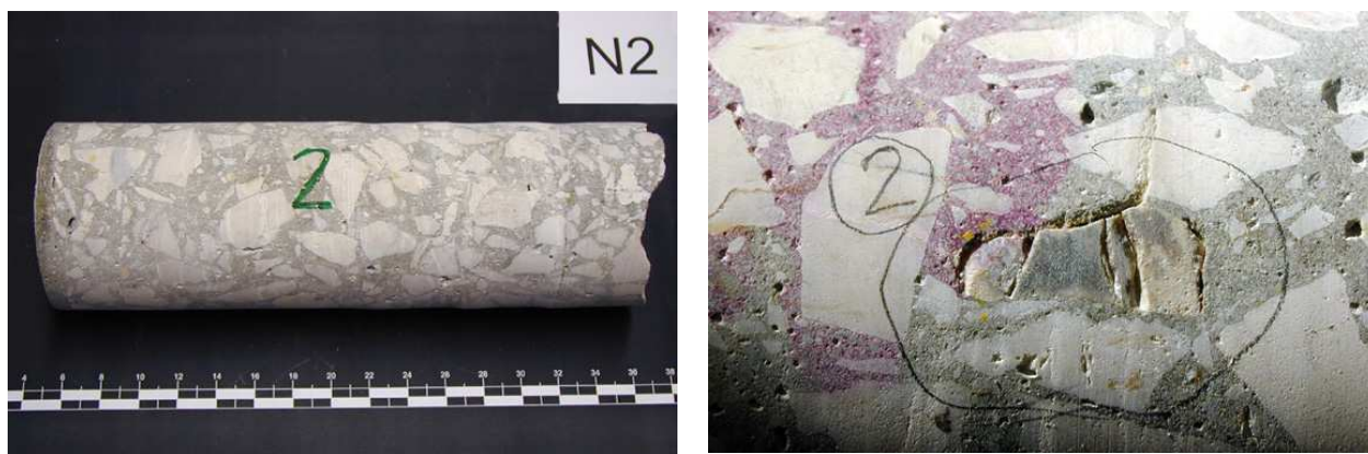
Figura 6 - Carote N2, sendo visíveis os inertes quartzíticos reactivos aos alcális
